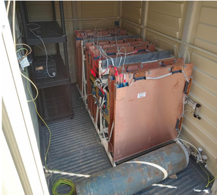
9. ábra. A kép a müográfiás detektorrendszert tartalmazza, a gázrendszerével és az energiaellátó rendszerével együtt. (Oláh, et al., 2025)
