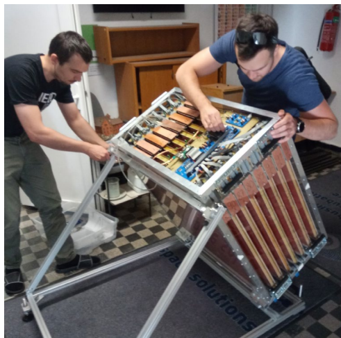
Földalatti bányászati és régészeti kutatásokhoz készült nagy méretű müoográfiai nyomkövető összeszerelése a Wigner Fizikai Kutatóközpontban
