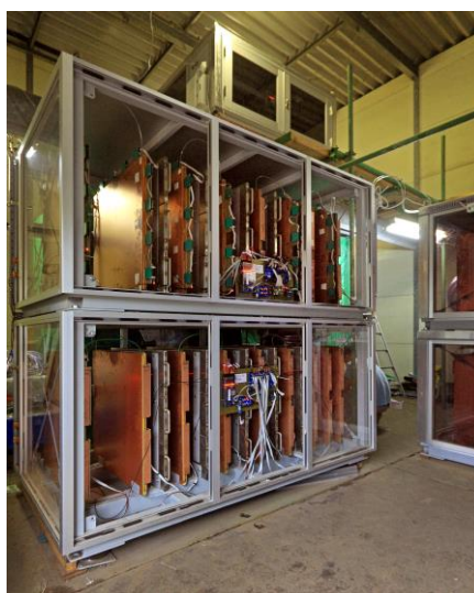
A Szakuradzsimavulkán magyar-japán együttműködésben fejlesztett műografikus megfigyelő rendszere (fotó: Oláh László)
